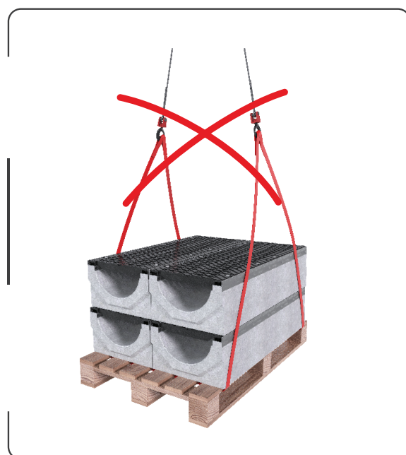
Рис. 3. Неправильная строповка паллета с водоотводными лотками.
