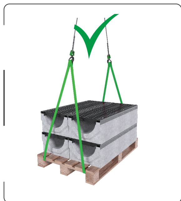
Рис. 2. Правильная строповка паллета с водоотводными лотками.
