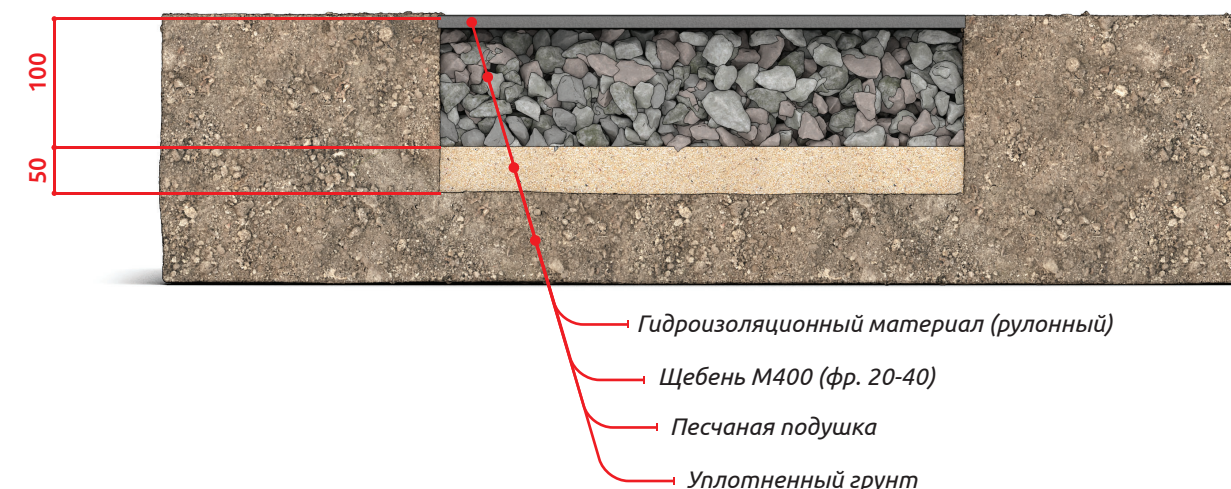
Рис. 6. Основание обоймы водоотводного лотка.
