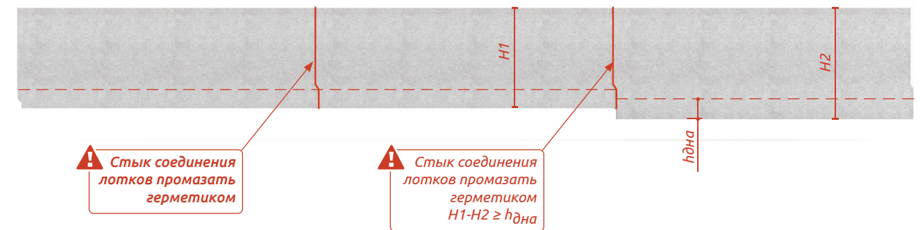
Рис.12. Соединение лотков СТИЛОТ одной высоты или близких высот.
