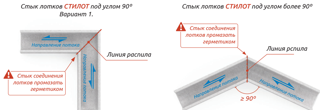
Рис.11.1. Схемы стыковки водоотводных лотков СТИЛОТ.
